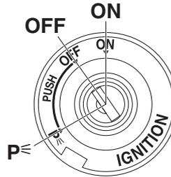
Das Zündschloss schaltet die Zündung sowie die Stromversorgung der anderen elektrischen Systeme ein und aus. Die einzelnen Schlüsselstellungen sind nachfolgend beschrieben.
