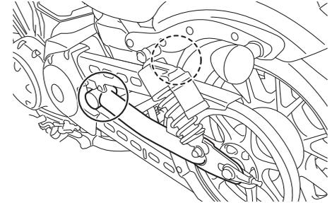
Die Schwingen-Drehpunkte müssen in einer Yamaha-Fachwerkstatt in den vorgeschriebenen Abständen geschmiert werden, gemäß der Tabelle für regelmäßige Wartung und Schmierung.
