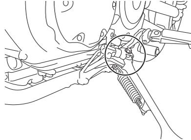
Die Funktion des Seitenständers sollte vor jeder Fahrt geprüft werden und die Drehpunkte und Metall-auf-Metall-Kontaktflächen sollten gegebenenfalls geschmiert werden.
