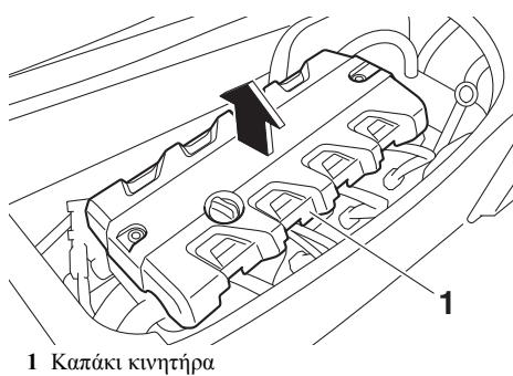
Για να τοποθετήσετε το κάλυμμα του κινητήρα:
