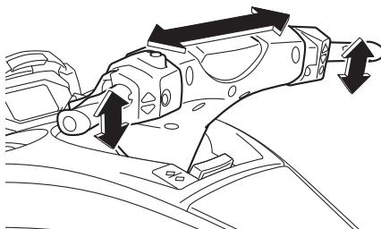
Περιστρέψτε τις χειρολαβές του τιμονιού τέρμα δεξιά και αριστερά για να βεβαιωθείτε ότι το ακροφύσιο πηδαλιουχίας κινείται καθώς περιστρέφονται οι χειρολαβές, καθώς και ότι δεν υπάρχει διαφορά μεταξύ των θέσεων τέρμα δεξιά
