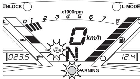
Αν ενεργοποιηθεί η προειδοποίηση ελέγχου κινητήρα, μειώστε αμέσως τις στροφές του κινητήρα, επιστρέψτε στην ακτή και ζητήστε από έναν αντιπρόσωπο της Yamaha να ελέγχει τον κινητήρα.
