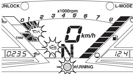
Αν ενεργοποιηθεί η προειδοποίηση πίεσης λαδιού, μειώστε αμέσως τις στροφές του κινητήρα, επιστρέψτε στην ακτή και ελέγξτε τη στάθμη λαδιού του κινητήρα. (Βλ. σελίδα 55 για πληροφορίες σχετικά με τον έλεγχο της στάθμης λαδιού του κινητήρα.) Εάν η στάθμη λαδιού υποδεικνύει επαρκή ποσότητα, απενθύνθείτε σε έναν αντιπρόσωπο της Yamaha για έλεγχο του υδροσκάφους.
