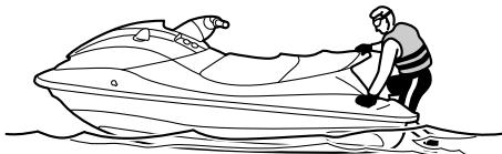
(3) Δέστε το κορδόνι ασφαλείας του κινητήρα (αναδέτης) στον αριστερό καρπό σας και, στη συνέχεια, τοποθετήστε την ασφάλεια στο διακόπτη ασφαλείας του κινητήρα.
